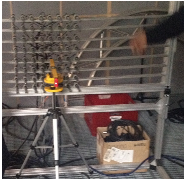
Abbildung 1: Messaufbau des 64-kanaligen planaren Arrays mit Laserwasserwaage zur geometrischen Einpassung der Lautsprecher im Winkel.
