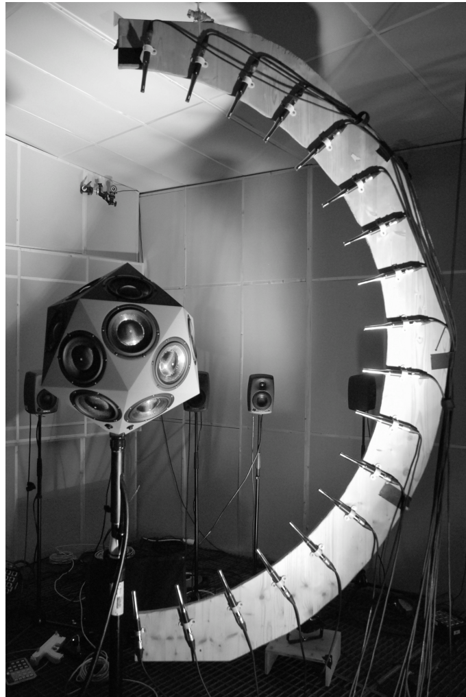
Abbildung 13 – Akustische Vermessung des Icosaeders im akustischen Messplatz von IEM mit 18 Messmikrofonen
